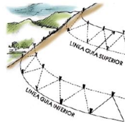
Figura 03 . Se procede a clavar estacas y las líneas en contorno
